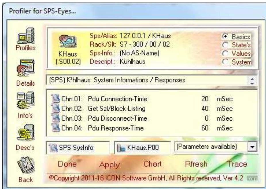
Es werden die Antwortzeiten der SPS aufgezeigt. Mittels des Buttons "Chart" lässt sich die Anzeige in eine Grafik umsetzen:
